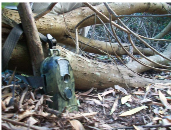
Figura 13. Equipo de fototrampeo na praia de Moledo oculto entre a vexetación para a identificación de depredadores e incidencias sobre a incubación.
